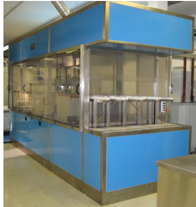
Elektropolierautomat für Kleineserienteile (Medizintechnik)
